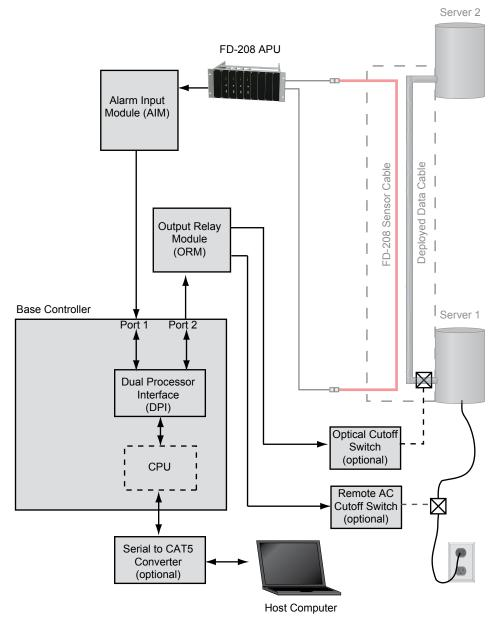
*Figure 6 - SecurLAN<sup>®</sup> component block diagram*
